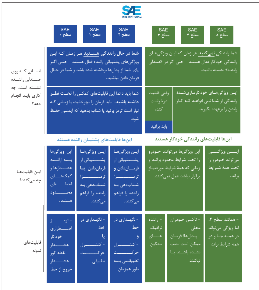
■ شکل شماره ۱. سطوح رانندگی خودکار بر اساس آنچه توسط SAE ترسیم شده است. https://www.sae.org/binaries/content/assets/cm/content/blog/sae-j3016-visual-chart_5.3.21.pdf
