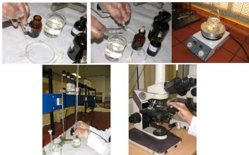
تصویر ۱۰- اندازه‌گیری آزمایش تعیین عدد کاپا و شناسایی نوع الیاف کاغذ
