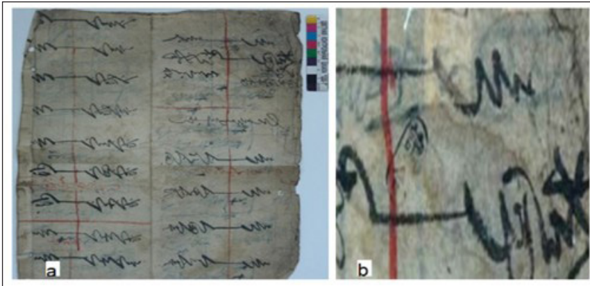
■ شکل ۷. تصاویر یک برگ از کتاب دست‌نویس عربی مربوط به قرون وسطی: (a) نمای کلی صفحه؛ (b) ناحیه‌ای که با لیزر پردازش و تمیز شده است (مستطیل روشن در وسط بالا)
