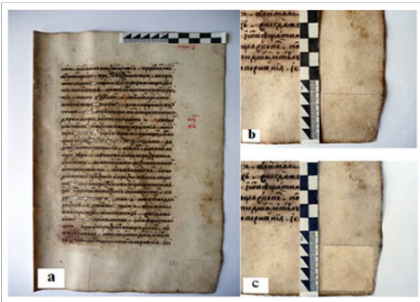
■ شکل ۵. صفحه‌ای از یک نسخه دست‌نویس روسی قرن هفدهم با آلودگی‌های سطحی مشخص: (a) وضعیت اولیه؛ (b) گوشه پایین سمت راست صفحه، با مداد علامت‌گذاری‌شده. ناحیه مورد تیمار لیزری؛ (c) همان ناحیه پس از تمیزکاری با لیزر
